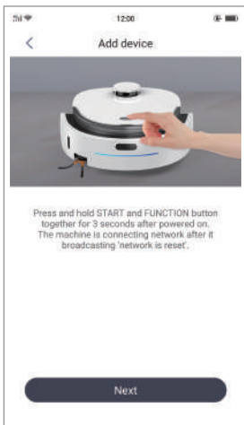
กดปุ่ม Start และ ปุ่ม Function พร้อมกัน และกดค้างไว้ 3 วินาทีหลังจากที่เครื่องเปิดแล้ว เครื่องจะทำการค้นหา WiFi เพื่อเชื่อมต่อโดยอัตโนมัติ และหากเชื่อมต่อล้มเหลวจะแจ้งเตือนว่า "Network is reset."
