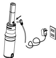
นอกจากนี้ คุณยังสามารถใช้ด้วยติดผนังเพื่อชาร์จผลิตภัณฑ์ได้ โปรดติดตั้งตัวยึดติดผนังบนผนังและเชื่อมต่อ กับอะแดปเตอร์ตามภาพที่แสดง:
