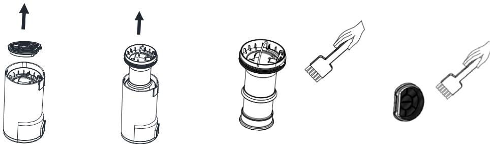
(3) ทำความสะอาดแผ่นกรอง HEPA ด้วยเบรร์ข้นฝุ่นหรือล้างด้วยน้ำอุ่นหรือล้างได้น้ำ
